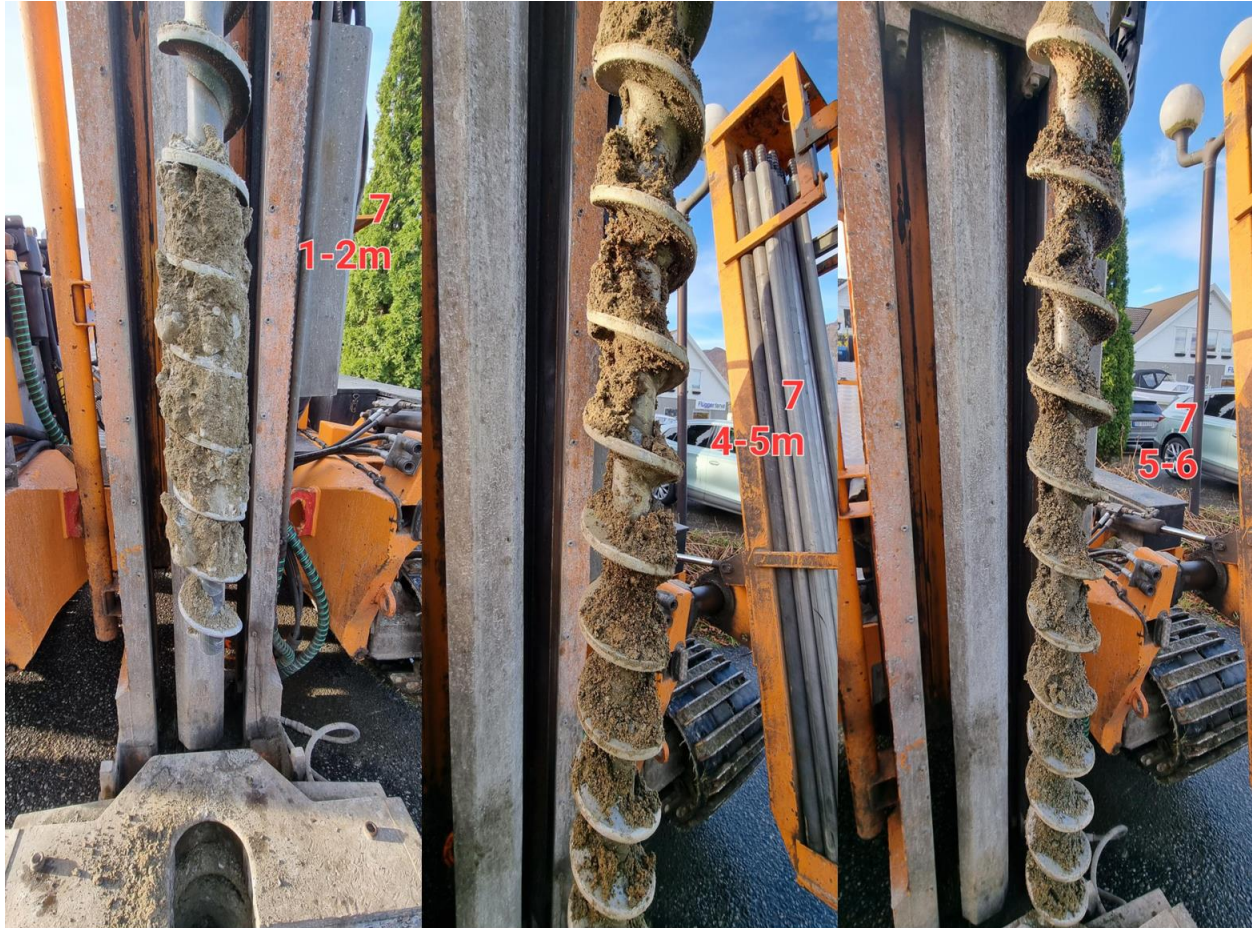
Figur 5: Bildene viser bilder av opptatt prøver i borpunkt 07 under de geotekniske grunnundersøkelsene.
