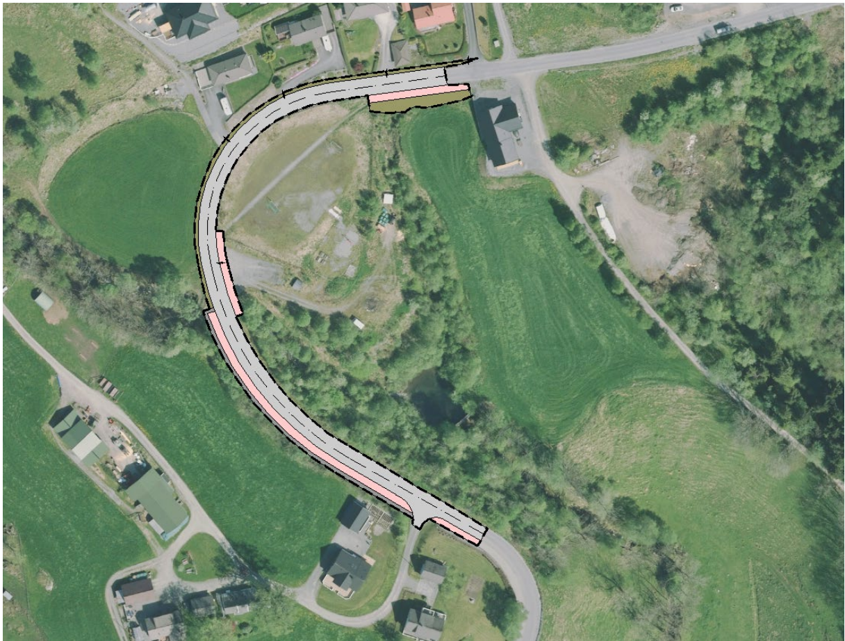
Figur 4 Planlagt vegstrekning med fortau saman med ortofoto.
