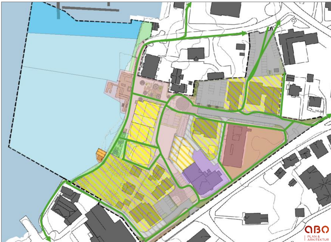
Figur 29 Gangsoner i planområdet. Skissa er ikkje oppdatert med endringar etter fyrstegangshøyringa då endringane ikkje påverkar situasjonen for gangsoner. ABO har utforma plandokumentet til 1. gangshøyring og etter dette er det Etne kommune som har teke over. På bakgrunn av dette er m.a. ikkje alle ABO illustrasjonane oppdaterte.
