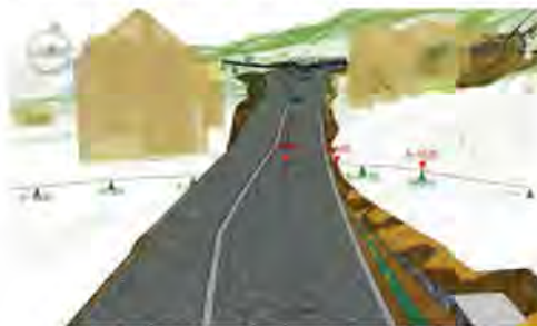
Figur 6-2: Innsnevring av miljøgateprofilen forbi eigedom med gnr. 27 bnr. 131 for å unngå mest mogeleg arealbeslag på eigedom. Til venstre: normalprofilen mellom profil 220 og 250. Til høgre: utsnitt frå vegmodellen som viser mogeleg utforming av fylkesveg forbi eigedom.
