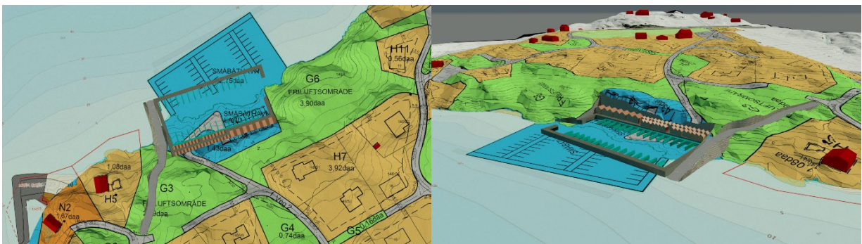
Figur 19 Alternativ 4. Et alternativ med slakkere stigning og rettere vei, på bekostning av snuareal. Konklusjon: Det viser seg likevel at man ønsker å ha mulighet til å kjøre helt inn til sjøbodene med tanke på transport av byggematerial, båtutstyr, og tilgjengelighet for uttrykningskjøretøy.
