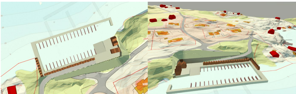
Figur 22 Alternativ 7 er en videreutvikling av alternativ 6. Moloen består av en lukket havn med 32 båt plasser, slipp, 28 sjøboder og 4 større sjøboder. Bil med tilhenger vil kunne snu, ved å kjøre fronten inn mot fjellveggen i øst, for så å rygge ut mot slippen, og så kjøre opp veien igjen. Det er satt opp fire større sjøboder i østlig ende.
